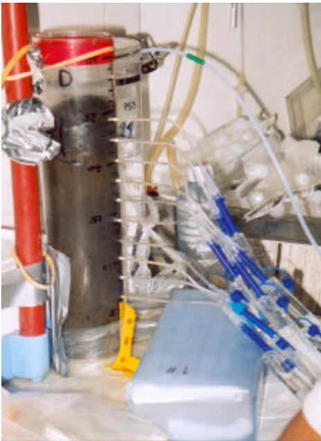
Figure 1 : utilisation des bougies poreuses sur une carotte de sédiment.
