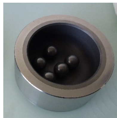
Illustration 3: Bol et billes en carbure de tungstène
