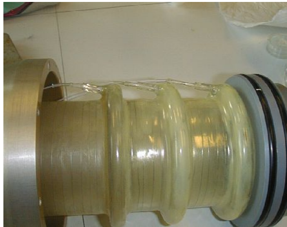
Photo 4 : Connexion des tubes Tygon sur les gouttières du collecteur
