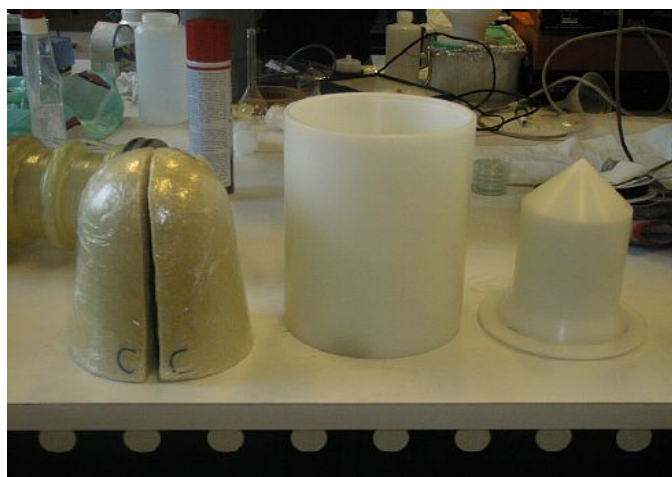
Photo 3 : La coiffe en polyuréthane et son moule
