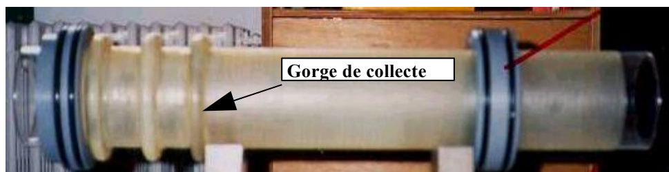
Photo 1 : corps du préleveur aéroporté : cylindre en verre
