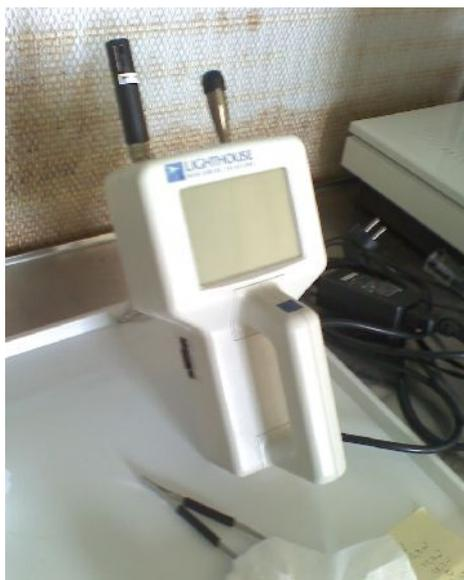
**Figure 19** : Photo du Capteur de particule
